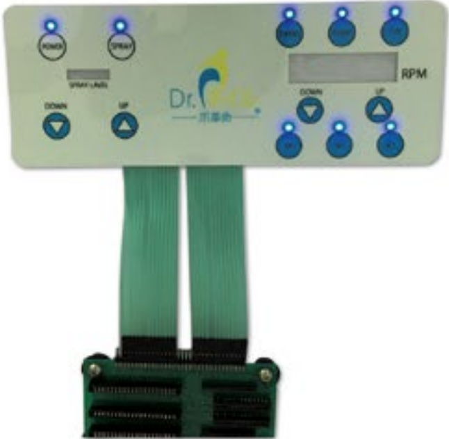
触碰薄膜开关，配有 LED 背光源和金属弹片
