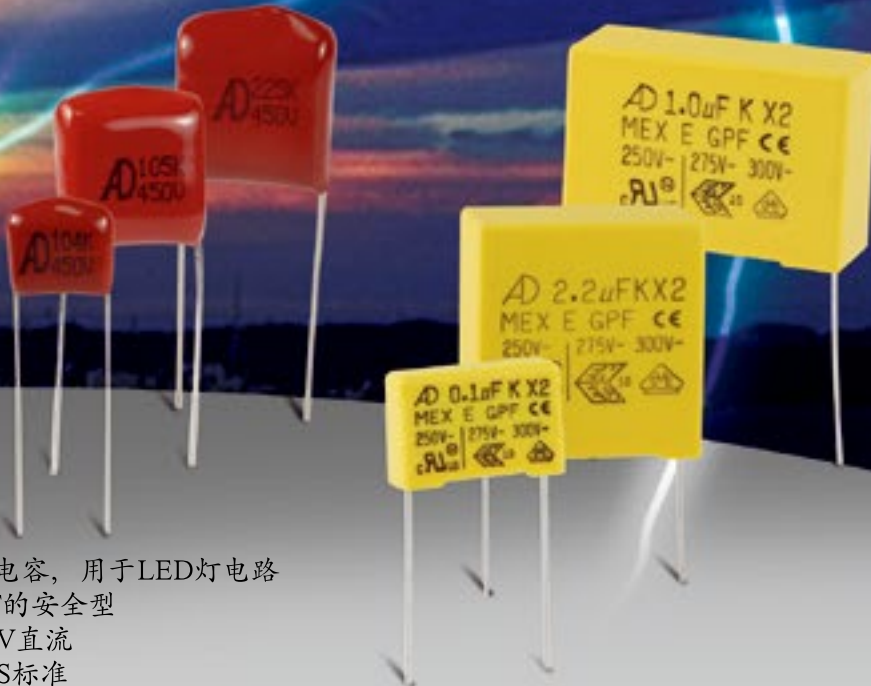
EMI抑制X2电容 • 0.01-10 \mu F的 • 300VAC • 符合RoHS标准
