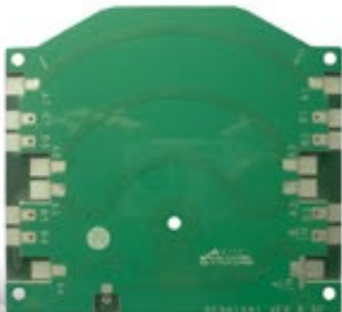
四层沉锡高频混压板
