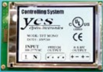
320 240 单一 TFT 液晶显示模块
