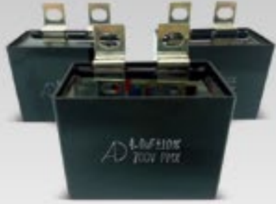
小型金属化电容，用于LED灯电路 • 0.1-2.2 \mu F的安全型 • 400和450V直流 • 符合RoHS标准
