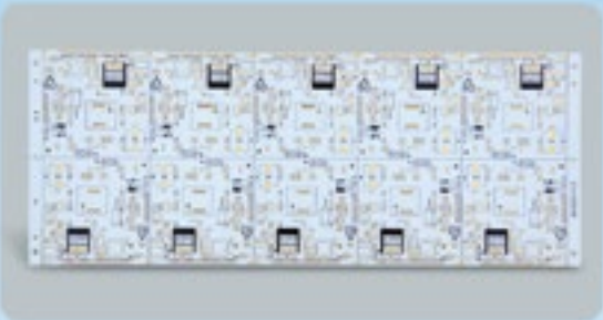
双面 PCB 板（板边 PTH 半孔）
