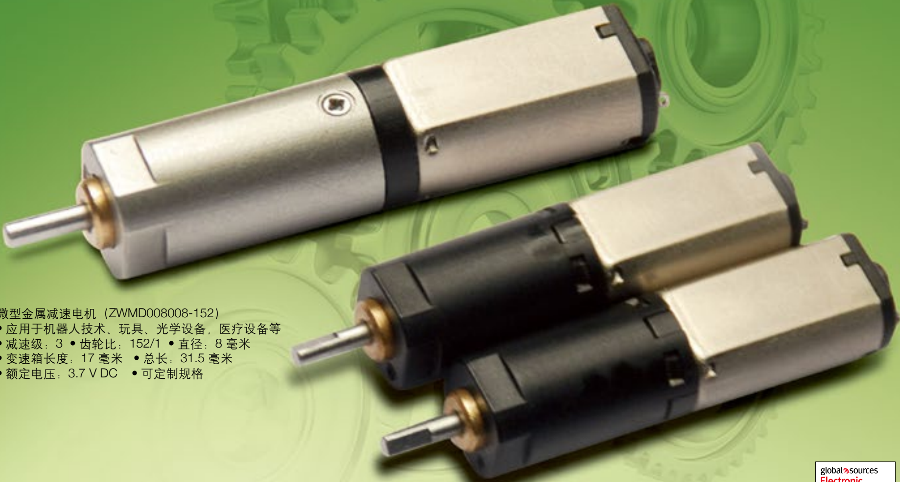
微型塑胶行星齿轮箱 (ZWPD008008-69) • 应用于机器人技术、玩具、医疗设备、电子锁等 • 减速级: 3 • 齿轮比: 69/1 • 直径: 8 毫米 • 变速箱长度: 14 毫米 • 总长: 28.5 毫米 • 额定电压: 4.2V 直流电 • 可定制规格
