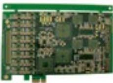
8层PCB板 • BGA技术 • 金手指表面光洁度
