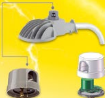
LED路灯用带内置电涌保护器的光控器 • 符合UL1449、UL773、ANSI C136.10、IEC61643-11和EN61643-11标准 • In: 5/10kA; Imax: 10/15/25kA可选
