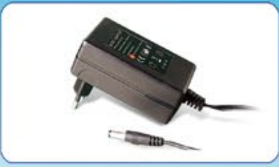
开关电源 • 输入：100~240V • 输出：3~24V DC, 0.5~48W • 适用于 A/V 设备、玩具、IT 产品
