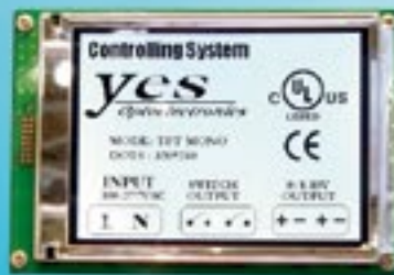
320 240 mono TFT-LCD module
